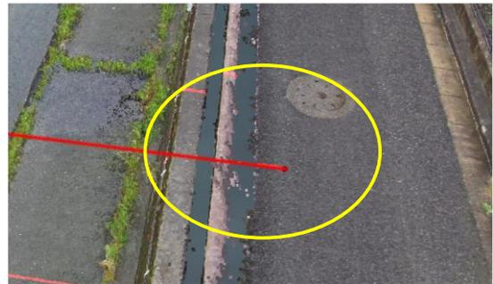
写真-2 河道の一部として認識される欄干
